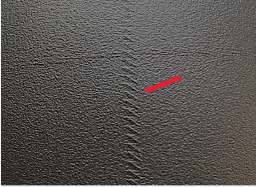
Şekil 2. Parçaların üzerinde yer alan lazer dikiş izi.
